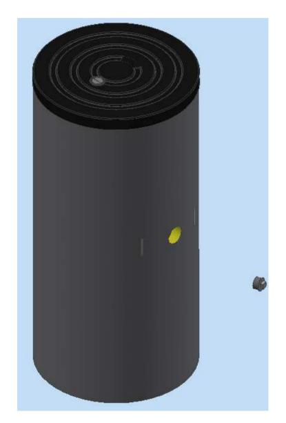
• Отвинтите заглушку с помощью гаечного ключа.
