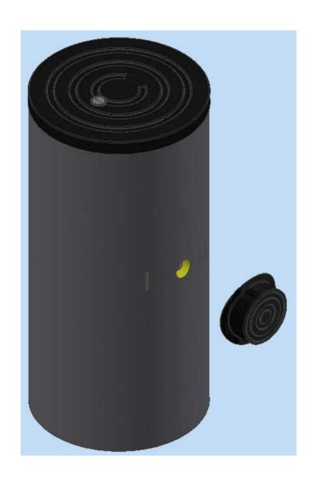
• Отвинтите два винта, которые крепят черную боковую крышку и снимите эту крышку.
